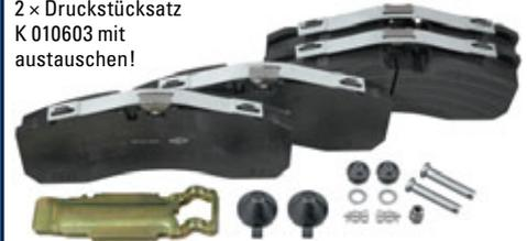
Bei jedem Bremsbelagwechsel müssen gemäß KNORR-BREMSE Serviceanleitung auch die als Zubehör aufgeführten Druckstücke mit Faltenbalgabdichtung geprüft und bei Bedarf erneuert werden. Es wird daher empfohlen diese bei jedem Belagwechsel mit auszutauschen, da auch kleine Undichtigkeiten hier zu Korrosion innerhalb der Zuspäneinheit und damit zum Totalausfall führen können.
