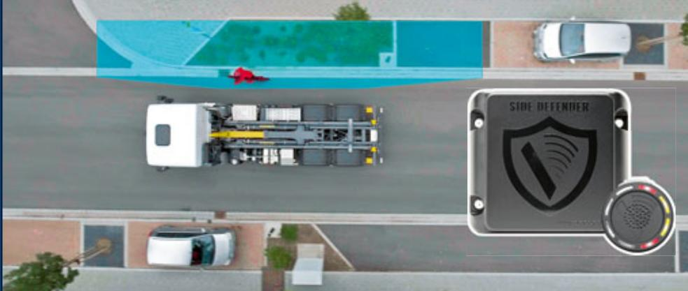
Das Abbiegeassistent-System AAS-GPS beruht auf dem PRECO PreView Side Defender® II FMCW-Radarsensor.
