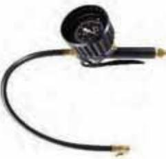
Der klassische Handfüllmesser ist das typische Profigerät für Tankstelle und Werkstatt, hunderttausendfach bewährt. Einhebel-Handgriff zum Prüfen, Ablassen und Füllen, stoßgeschütztes Präzisionsmanometer (80 mm) mit Schutzkappe, Schlauch mit Momentstecker, Gehäuse Aluminium eloxiert.
