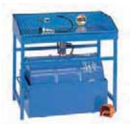
Teilereinigungsgerät in Werkbankgröße mit sehr großer Arbeitsfläche für die industrielle Teilereinigung.
