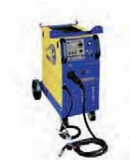
Die T1 GYS auto ist ein halbsynergisches geregeltes Schutzgasschweißgerät, konzipiert für Schweißarbeiten an Stahl- Edelstahl- und Aluminiumdünnblechen. Es verfügt über einen 4-Rollen Drahtvorschub und eignet sich zum MIG Löten von hochfestem Stahl mit CuSi und CuAl- Draht (ideal für Karosseriereparaturarbeiten).
