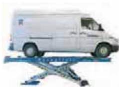
Elektrohydraulisch, für PKW und Transporter (auch mit langem Radstand) bis 5,0 to. Überflurausführung mit flachen Fahrschienen.
