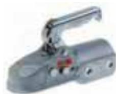
Zugkugelpkupplung aus Temporguss für Anhänger mit einem Gesamtgewicht bis 3500 kg, Bohrungen horizontal, Bohrungsabstand 54 mm.
