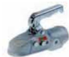
Zugkugelpkupplung aus Temporguss für gebremste Anhänger bis zu einem Gesamtgewicht von 3500 kg, kreuzgebohrt, Bohrungsabstand 40 mm.
