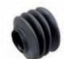
Der Faltenbalg verhindert Schmutz- und Witterungseinwirkung an der Schubstange der Auflaufbremse, somit ist bei entsprechender Wartung und Pflege die Funktionsfähigkeit der Auflaufbremse gewährleistet.
