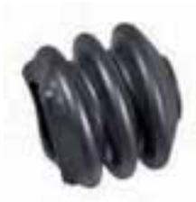
Der Faltenblag verhindert Schmutz- und Witterungseinwirkung an der Schubstange der Auflaufbremse, somit ist bei entsprechender Wartung und Pflege die Funktionsfähigkeit der Auflaufbremse gewährleistet.
