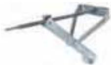
Die Steckstützen können bei allen Wohnwagen mit ALKO Chassis, sowie an allen Fahrgestellen anderer Hersteller nachgerüstet werden. Die Stützen garantieren einen sicheren Stand des Wohnwagens.
