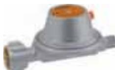
Niederdruckregler zum Anschluss an Gasflaschen, zur Druckreglung auf den Nennndruck des Gasgerätes. Mit Entlüftungsstopfen, der gleichzeitig das Eindringen von Feuchtigkeit, z.B. Regenwasser, in das Reglerinnere verhindert. Für den Einsatz der Regler-Enteisung (Eis-Ex) empfehlen wir die Regler mit Manometer zu verwenden.
