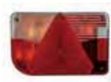
4-Kammer Heckleuchte mit Schlusslicht, mit Blinklicht, mit Bremslicht. Dreieckrückstrahler. Bajonett, inkl. Glühlampen. Je nach Einbauseite mit Nebelschluss- oder Rückfahrlicht.
