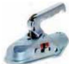
Zugkugelpkupplung aus Temporguss für gebremste Anhänger bis zu einem Gesamtgewicht von 3500 kg, kreuzgebohrt, Bohrungsabstand 40 mm.
