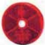
Wirksame Rückstrahlfläche 22 cm<sup>2</sup>, mit Kunststoff-Bodenplatte, 1 Loch Bohrung Ø 6 mm für Befestigungsschraube.
