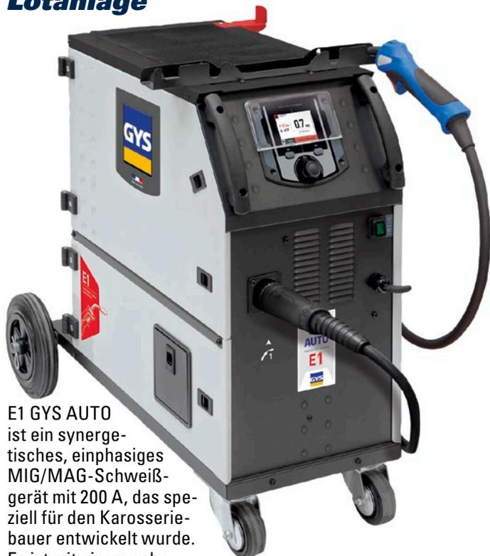
E1 GYS AUTO ist ein synergisches, einphasiges MIG/MAG-Schweißgerät mit 200 A, das speziell für den Karosseriebauer entwickelt wurde. Es ist mit einem sehr intuitiven, farbigen Bedienfeld ausgestattet und schweißt Stahl und Aluminium auch bei geringen Stärken perfekt zusammen. Seine Synergien umfassen auch Schweißlötten mit CuSi3- und CuAl8-Drähten.
